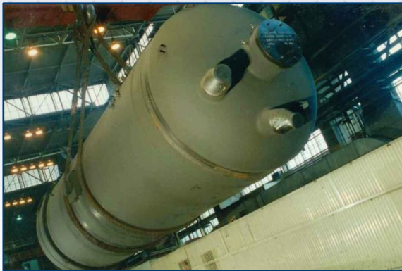
Tlakové zařízení VVER 1000 – dodávka pro NPP Belene (Bulharsko) a Temelin (Česká republika)
