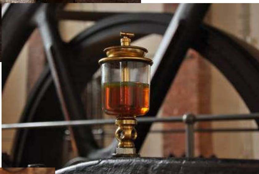
Ještě jeden pohled do strojovny a detail maznice
