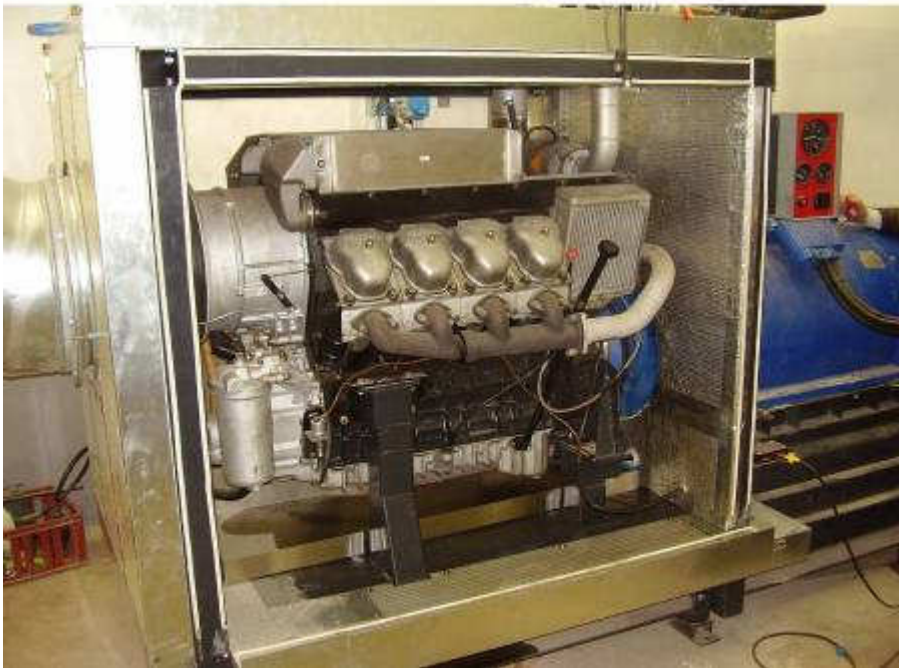
První kogenerační jednotka s motorem TATRA v ČR instalovaná u firmy TŮMA
