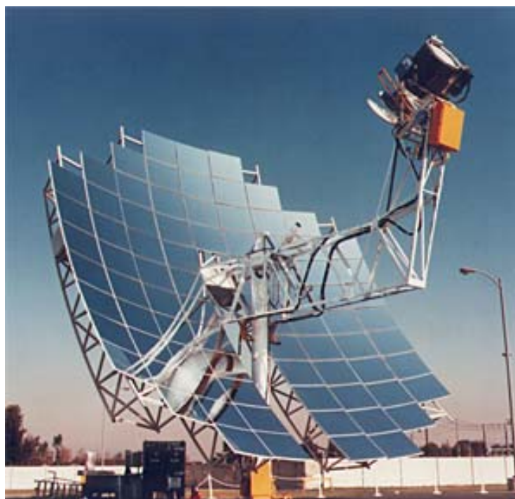
Solární jednotka SES, 25 kW
